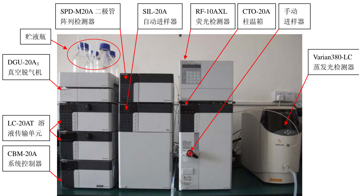
岛津 LC-20AT 型高效液相色谱仪
